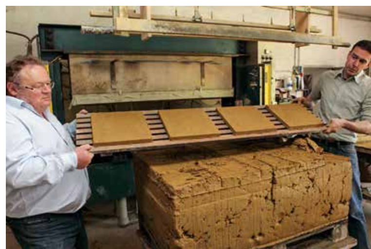
Bild oben: Jeder gewogene Rohling wird einzeln in einer speziell für diesen Zweck konstruierten Presse aufgehäuft. Mitte: Im ersten Schritt erhält der künftige Bodenziegel seine ungefähre Form. Bild unten: Im zweiten Schritt entsteht unter wachsendem Druck eine recht gleichmäßige und verdichtete Platte.
