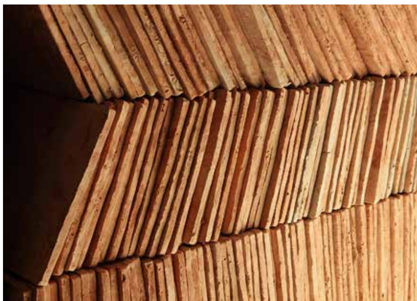
Fertig zum Verlegen: Die auf traditionelle Weise hergestellten Bodenziegel gibt es in verschiedenen Größen und Stärken. Sie eignen sich auch gut als Belag über Fußbodenheizungen. Für Böden in oberen Häusergeschossen gibt es dünnere und damit leichtere Exemplare.
